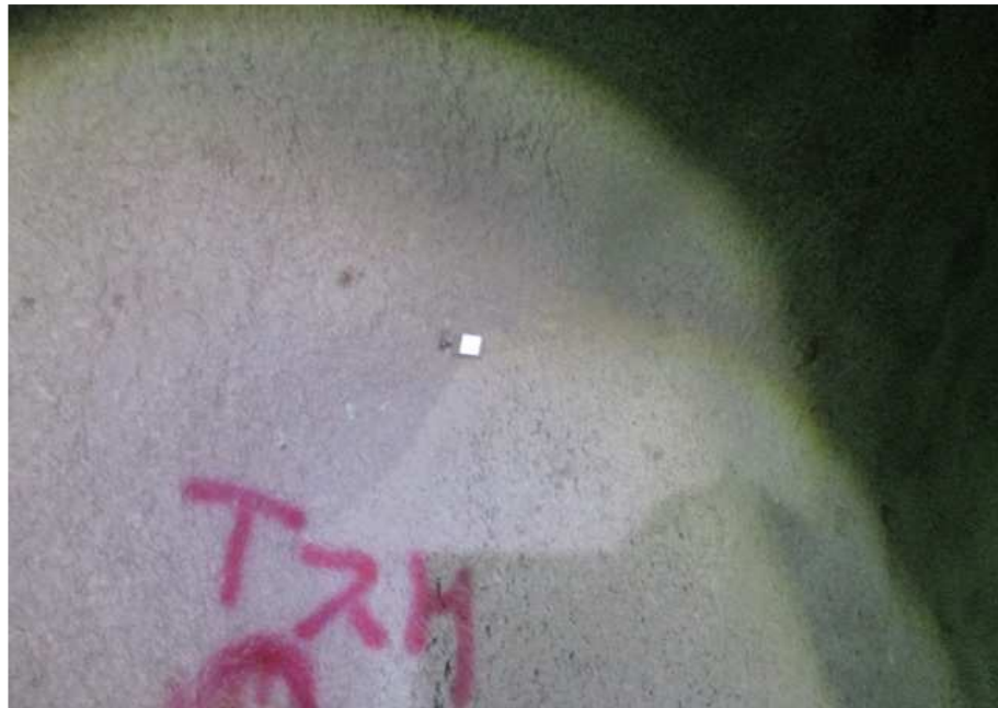
STA 0+920 내공 계측 현황
